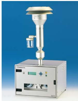
従来は測定困難であった低濃度領域での感度に改良を加え、PM2.5の分粒装置を装備した2.5μm50%カットの微小粒子を精度よく連続的に測定できる装置です。
