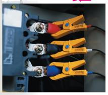
3129,3129-10は、静電誘導式電圧クリップ を用いた三相電路の相順チェックが電線の 被覆の上からクリップ可能な検相器です。
