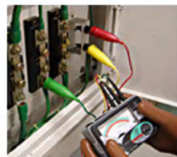
接地端子盤での作業効率アップ (MODEL 7241:オプション)
