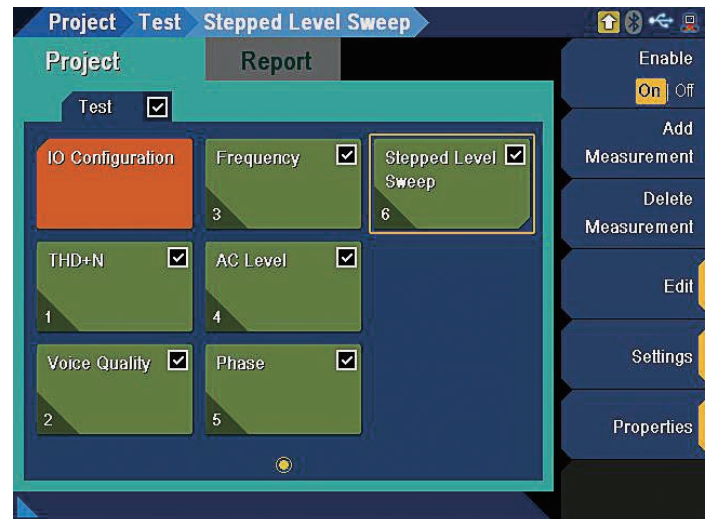
図9. テストシーケンス制御機能では、設定済みの測定の中から最も頻繁に使用するテストシーケンスを選択できます。
