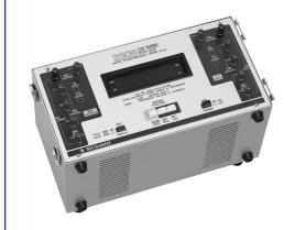
位相、周波数測定での生産設備から発生器、計測器の 計器校正標準器そして現場計測まで幅広い機能
